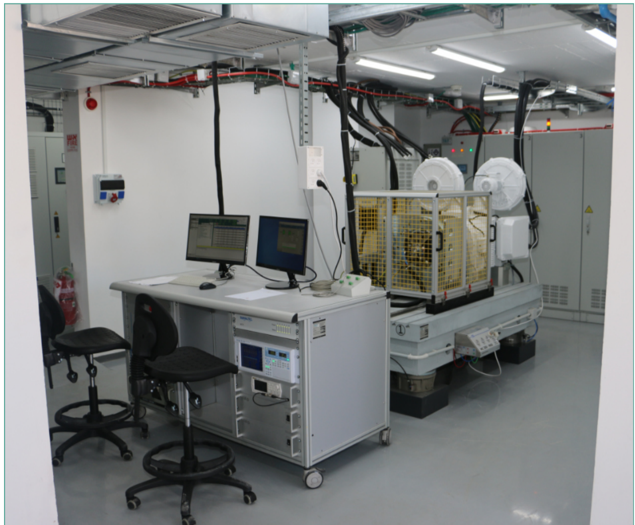
Ví dụ Bàn kiểm Động cơ Máy bay điện bao gồm các khả năng thử nghiệm động cơ từ 1 kW lên tới 140 kW, cùng với phần cứng
